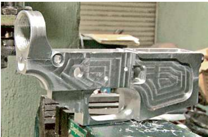
■ Este es el cuerpo o esqueleto de un AR-15; es de aluminio. A la estructura se le montan las otras piezas.
